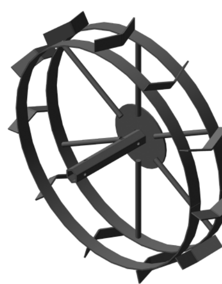
обод выполнен из нескольких полос металла
